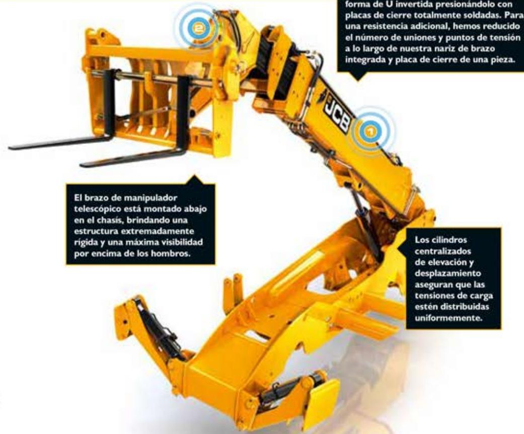
Hemos adaptado un resistente brazo con forma de U invertida presionándolo con placas de cierre totalmente soldadas. Para una resistencia adicional, hemos reducido el número de uniones y puntos de tensión a lo largo de nuestra nariz de brazo integrada y placa de cierre de una pieza.
